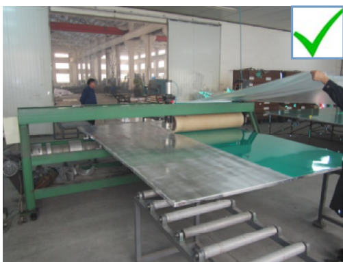
图 6-2-3 标志生产车间贴膜设备
